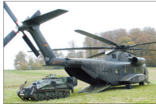
Flugabwehrraketenwaffenträger OZELOT bei Entladung aus mittlerem Transporthubschrauber CH 53
