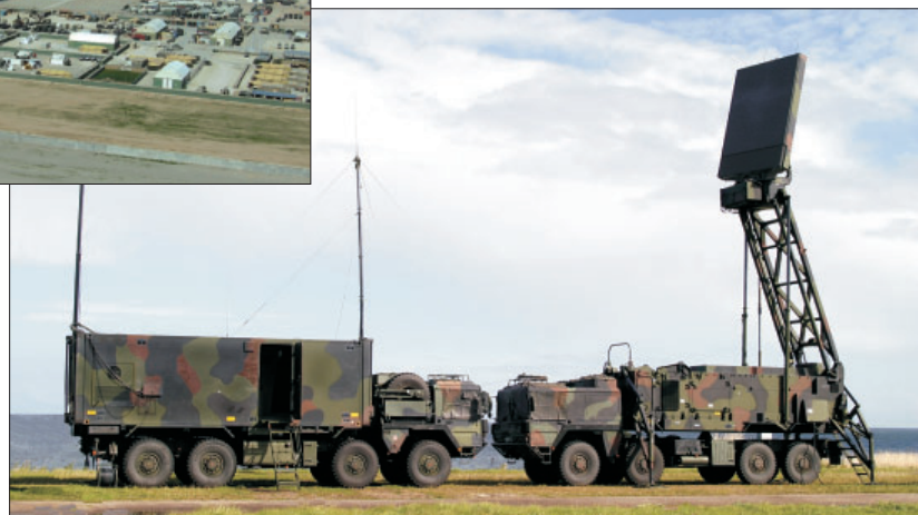
Luftraumüberwachungsradar (Auswerter und Sensor)
