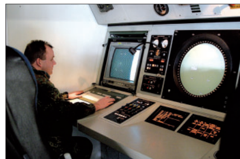
Arbeitsplatz im Luftraumüberwachungsradar (Auswerter)
